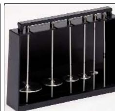
Soporte y husillos estándar R2, R3, R4, R5, R6 y R7 para modelo R. (Husillo R1 ver accesorios).
